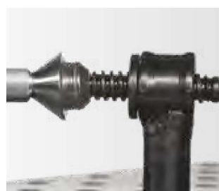
Druk- en steunstukken met kegel Opspannen van buizen met Ø 10 – 58 mm
