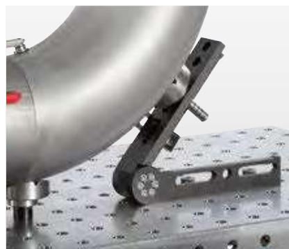
Optimaal voor het opspannen van werkstukken met flexibele uitlijningen
